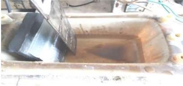
الشكل رقم(3) يوضح شكل خلية التحليل الكهربائي المستخدمة في إنتاج NaOH
