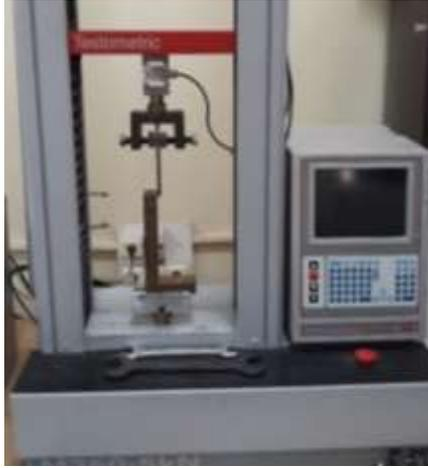
الشكل 3 - جهاز اختبار الميكانيك العام Testometric
