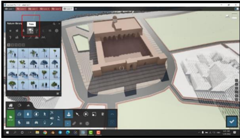
الصورة (18) توضح طريقة اختيار المادة المناسبة من حجر وخشب وإكسائها للجامع
