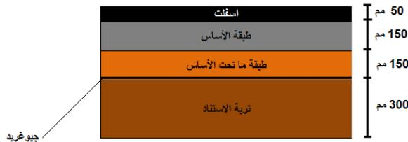
الشكل (3) طبقات الرصف الاسفلتي
